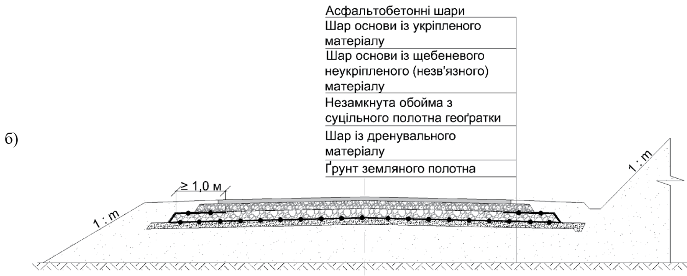
Армування зернистого шару незамкненою обоймою ГГ (суцільне полотно)
